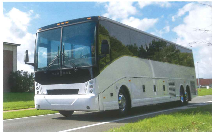
Van Hool lanceert in 2019 op de Noord-Amerikaanse markt een eerste vol-elektrisch aangedreven autocar CX45E met een realistische actieradius van zo'n 300 km.
